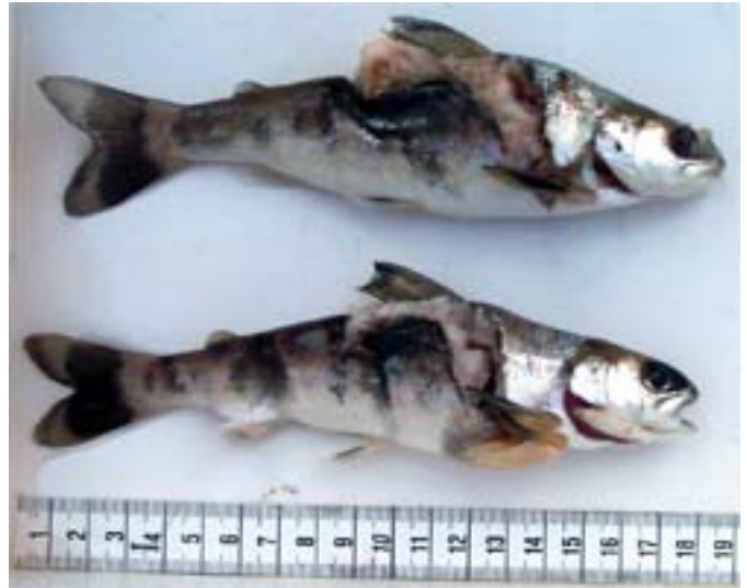
Abb. 2: Smolts nach Turbinenpassage (Lahn); Photo: Schneider
